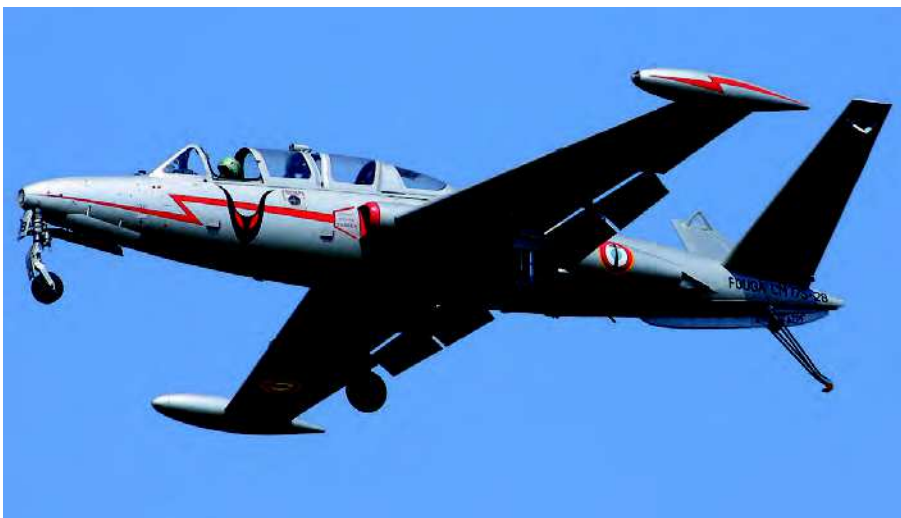
À la différence du CM-170, le CM175 Zéphyr possède une verrière coulissante qui permet de voler "en décapotable".
