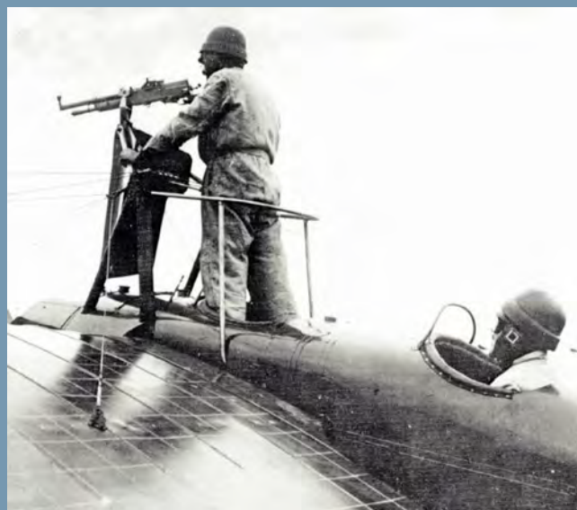
Installation "déraisonnable", sur un monoplane, pour tirer au-dessus de l'hélice.
