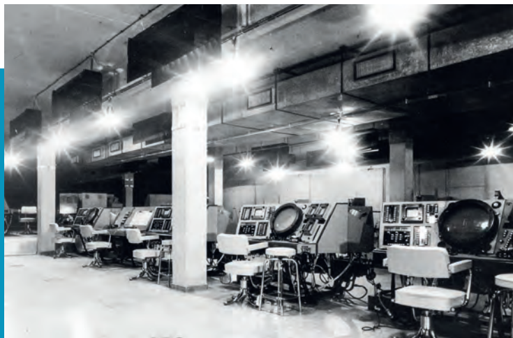
Salle d’opérations équipée des consoles STRIDA II.
