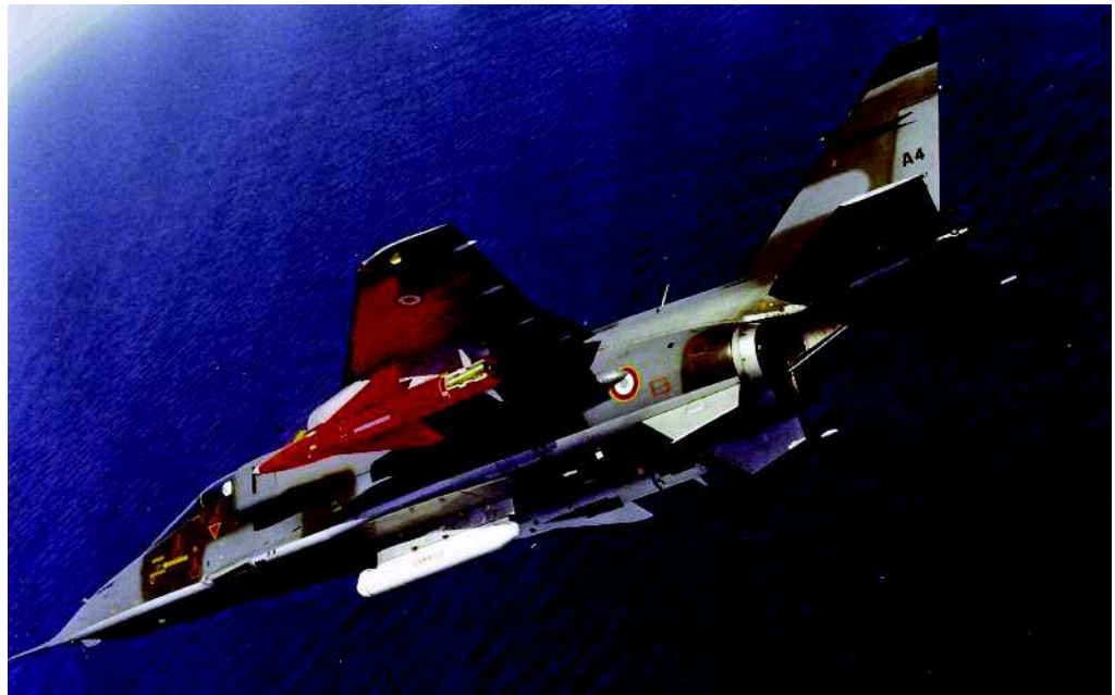
Le Jaguar A4 équipé du pod ATLAS et de 2 AS 30 L.
